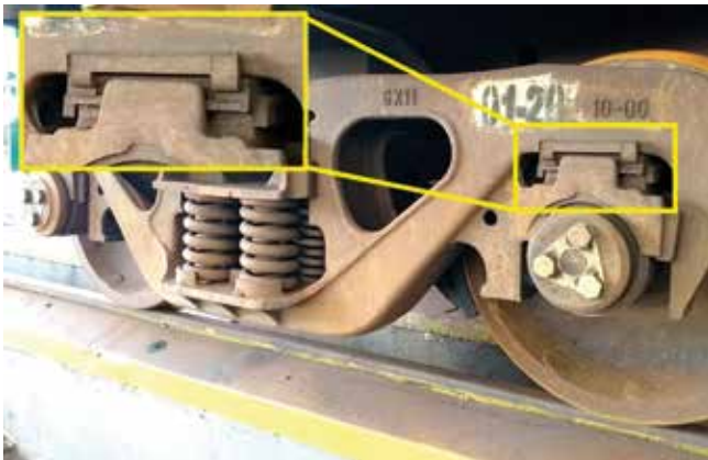
Fig. 1 - PAD instalado no truque
